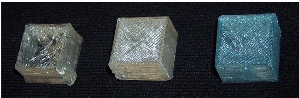
Abbildung 4.1: Hohlquader gedruckt mit Default-Einstellungen der Java-Host-Software (links) und mit kalibrierten Parametern in Skeinforge (mitte und rechts)
